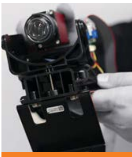
Etter at komponentene i kamerateknologien er sammenstilt, monteres teknologien inn i kameraboksen. Etter at sammenstillingen er komplett blir produktet testet hos NOCA.
